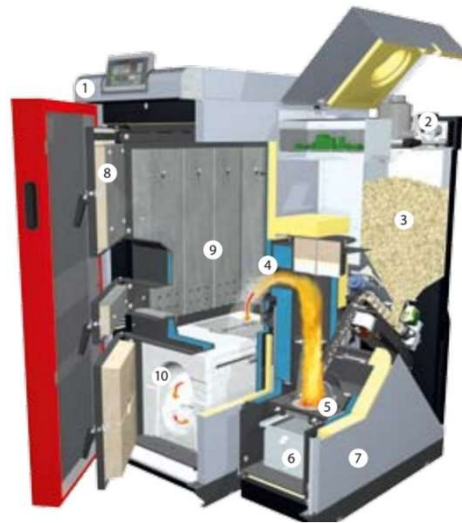
1 Scheitholz-Pellet-Kombikessel mit einer Brennkammer
